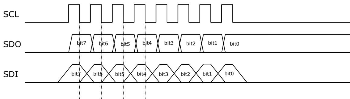
SPI 通信は、High から Low に変化したときに SDI からデータを取り込み、Low から High に変化したときに SDO の出力を変化させます。
