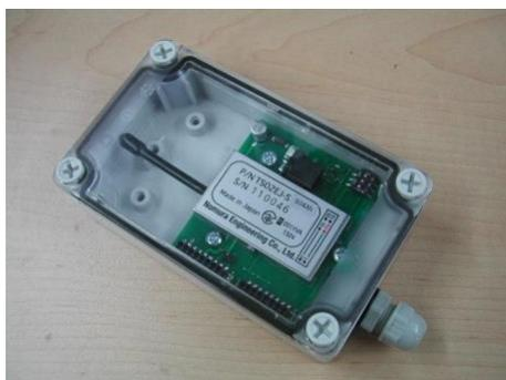
(写真はクリアのフタ / S アンテナ)
