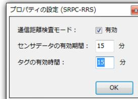
通信距離検査モードを有効にすると、無線信号強度が弱い場合、ステータスLEDが点滅するようになるモードになります。
