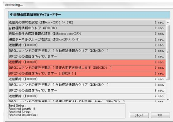
エラー時のアップロード画面でOKを押すと、アップロード画面が閉じられます。リトライを押すと、エラーが発生した項目から再アップロードが始まります。エラーが発生した項目は赤色で表示されています。
