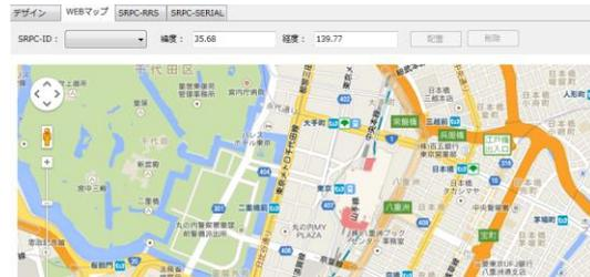
SRPC-IDのコンボボックスを操作して、配置するSRPCを選びます。既に配置されているSRPCを選ぶと地図の表示がそのSRPCの場所へジャンプします。
