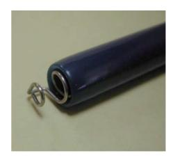
アンテナを基板に垂直に立てるために はラジオペンチなどで1回で曲げるよ うにしてください。 なんども曲げますと、折れてしまう場合
