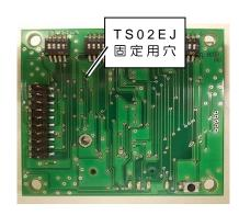
TSO2EJ モジュールにモジュール付属の絶縁シートを貼り付けてから、本機の TSO2EJ 接続コネクタに差し込みます。差し込んだら、基板の固定穴にモジュール付属のネジで固定します(ネジ固定は1カ所です)。詳細は、TSO2EJ ハードウェア共通仕様書を参照してください。
