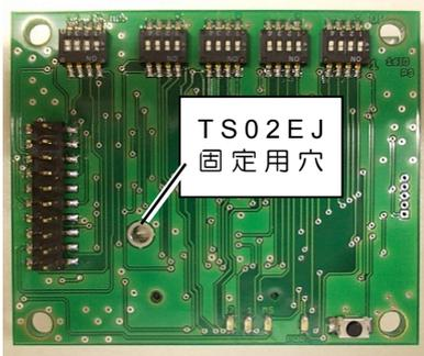
TS02EJ モジュールにモジュール付属の絶縁シートを貼り付けてから、本機の TS02EJ 接続コネクタに差し込みます。差し込んだら、基板の固定穴にモジュール付属のネジで固定します（ネジ固定は1カ所です）。詳細は、TS02EJ ハードウェア共通仕様書を参照してください。
